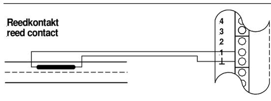
Auch **sehr kurze Schaltimpulse** werden vom Rückmeldemodul **RM-88-N** weitergeleitet, da sie bis zum Abruf von der Digitalzentrale oder dem Interface über den s88-Rückmeldebus **gespeichert** werden.
