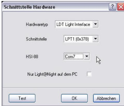
**Abbildung 47: Konfiguration HSI-88 Schnittstelle**
