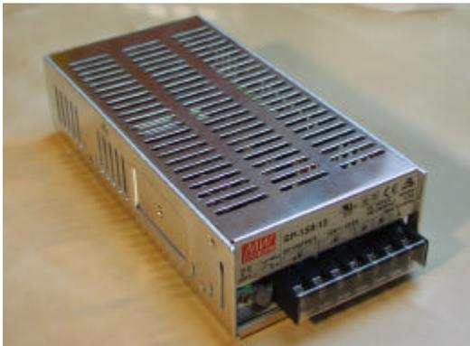
**Abbildung 6: 150W Schaltnetzteil (Reichelt)**
