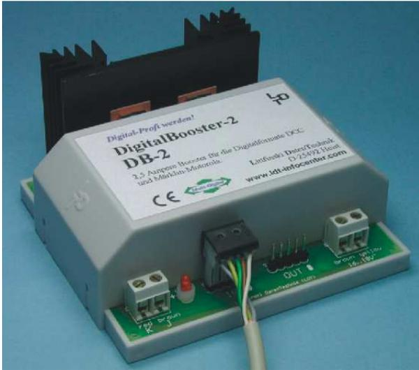
Der **DigitalBooster DB-2** ist ein **kurzschlussfester** Leistungsverstärker (Booster) für digitale Modellbahnanlagen. Er liefert einen **Digitalstrom von 2,5 Ampere**. Der **DigitalBooster DB-2** ist geeignet für die Digitalformate **Märklin-Motorola, mfx®, M4 und DCC**.
