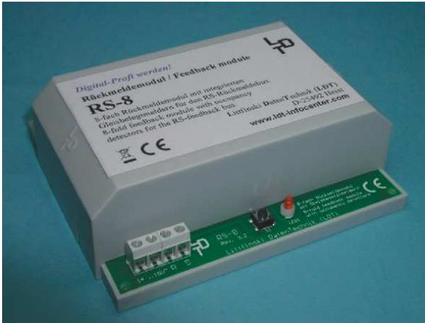
Das Rückmeldemodul **RS-8** ist mit **Gleisbesetzmeldern** ausgestattet und eignet sich somit zur **Überwachung** von jeweils **8 Gleisabschnitten**.
