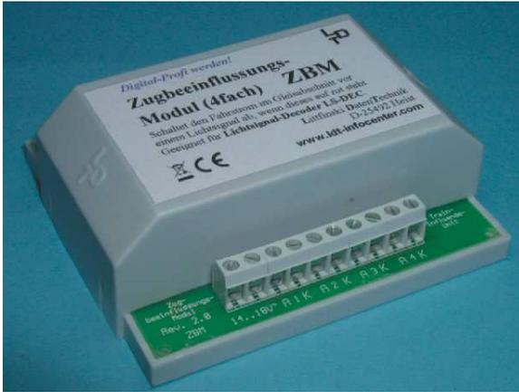
Mit dem **Zugbeeinflussungs-Modul ZBM** ist es möglich, Gleisabschnitte vor Signalen, die über den Lichtsignal-Decoder LS-DEC angesteuert werden, **spannungsfrei zu schalten**.
