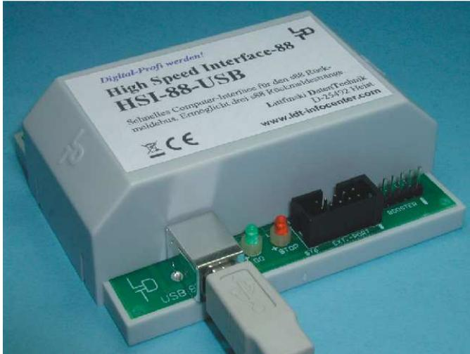
Beim **HSI-88-USB** handelt es sich um ein **Rückmeldeinterface** vom **s88-Rückmeldebus** zur **USB-Schnittstelle** eines Computers.
