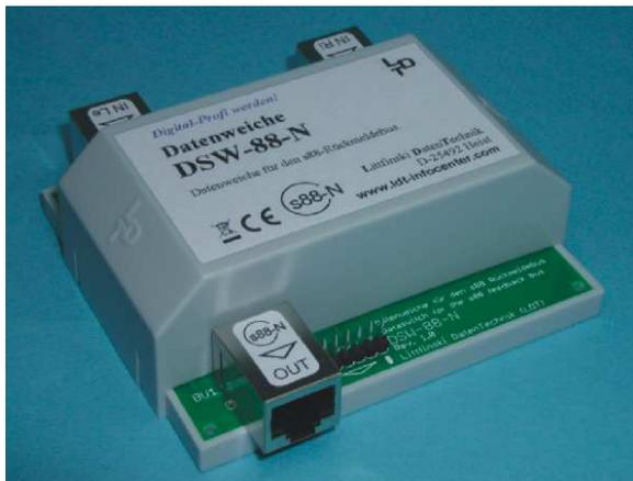
Beim s88-Rückmeldebus werden alle Module hintereinander in einem Busstrang verlegt. Mit der **Datenweiche DSW-88-N** haben Sie die Möglichkeit, den **s88-Rückmeldebus** zu **verzweigen**.
