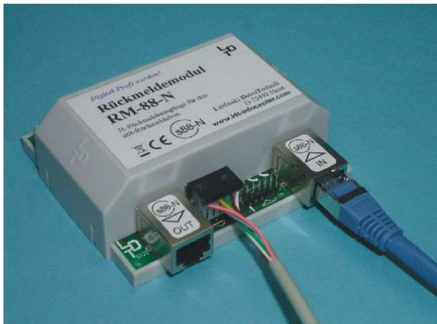
**Standard-Rückmeldemodul** für Digitalzentralen und Interfaces mit **s88-Rückmeldebus**.
