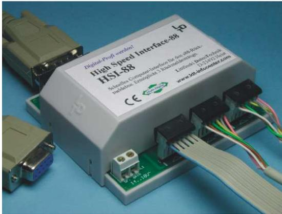
Beim **HSI-88** handelt es sich um ein **Interface** vom **s88-Rückmeldebus** zur **COM-Schnittstelle** eines **Computers**. Dadurch gelangen die Rückmeldungen **ohne Umweg über die Digitalzentrale direkt in den PC**.
