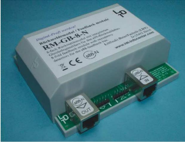
**Rückmeldemodul** mit integrierten Gleisbelegmeldern für Digitalzentralen und Interfaces mit **s88-Rückmeldebus**.
