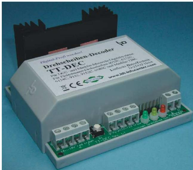
Der **Drehscheiben-Decoder (TurnTable-Decoder) TT-DEC** ist geeignet für die digitale Ansteuerung von **Fleischmann-Drehscheiben 6052, 6152, 6154, 6651, 9152, 6680** (jeweils mit und ohne "C"), **6652** (mit 3-Leiter Gleis), der **Roco-Drehscheibe 35900** und der **Märklin-Drehscheibe 7286**.
