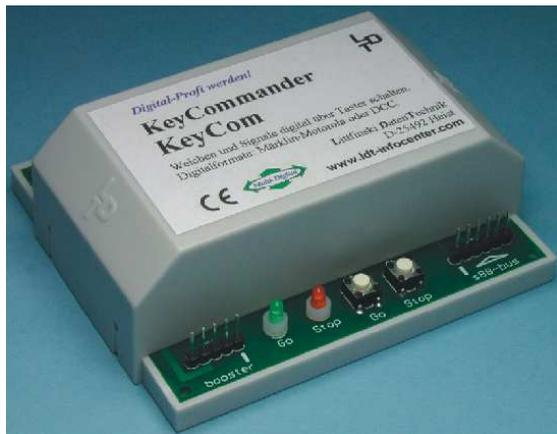
Mit dem **KeyCommander** können auch auf **Analoganlagen** Weichen und Signale über Taster **digital geschaltet** werden.
