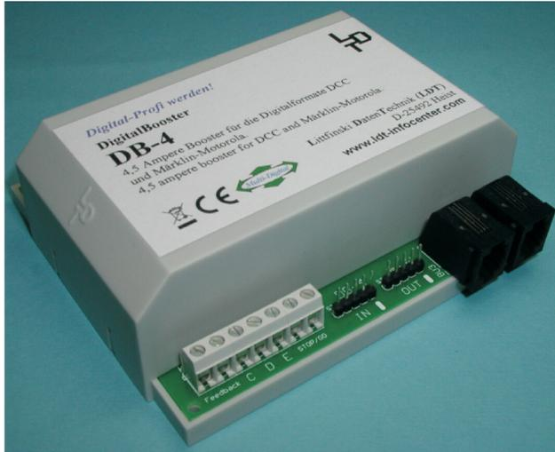
Der DigitalBooster DB-4 liefert bis zu 4,5 Ampere Digitalstrom. Sein Digitalausgang ist kurzschlussfest und über seine galvanisch getrennten Boosterbus-Anschlüsse kann er im Zusammenspiel mit vielen Digitalzentralen eingesetzt werden: Über den 5-poligen Boosterbus z.B. mit Märklin Control Unit, Central Station 1 und 2 und unserer DiCoStation, über den CDE-Boosterbus z.B. mit Lenz Digital plus, Intellibox, TWIN-Center, EasyControl, ECoS und
